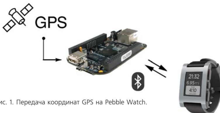
Рис. 1. Передача координат GPS на Pebble Watch.
